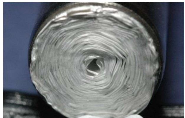
Abbildung 2: Zusammengerollte Lagen im Gehäuse [2]
